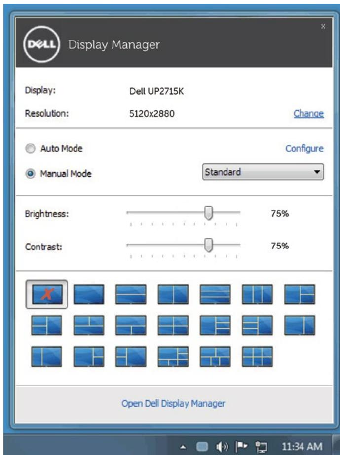
A caixa de diálogo de configurações rápidas também fornece acesso à interface avançada do usuário do Dell Display Manager, que é usada para ajustar as funções básicas, configurar o modo automático e acessar outros recursos.
